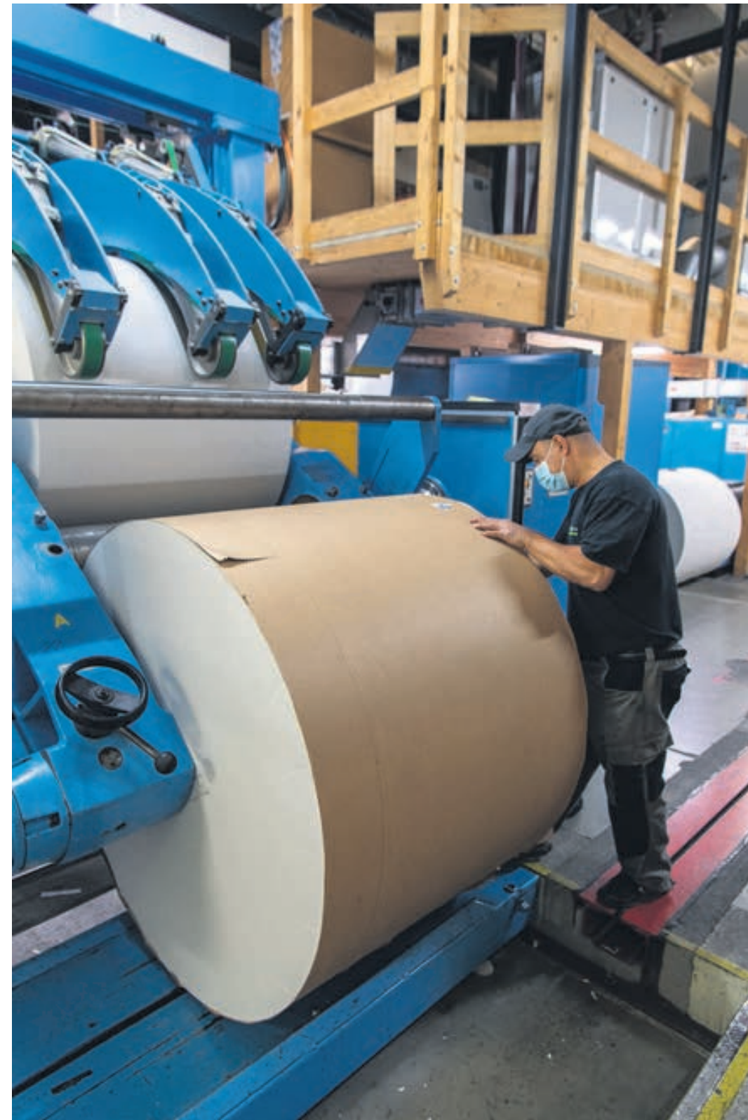
Les rouleaux de 1000 kilos de papier recyclé doivent être ajustés dans la machine avec précision.
