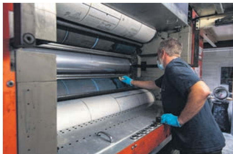
La rotative, après désencrage automatique, est encore nettoyée à la main.
