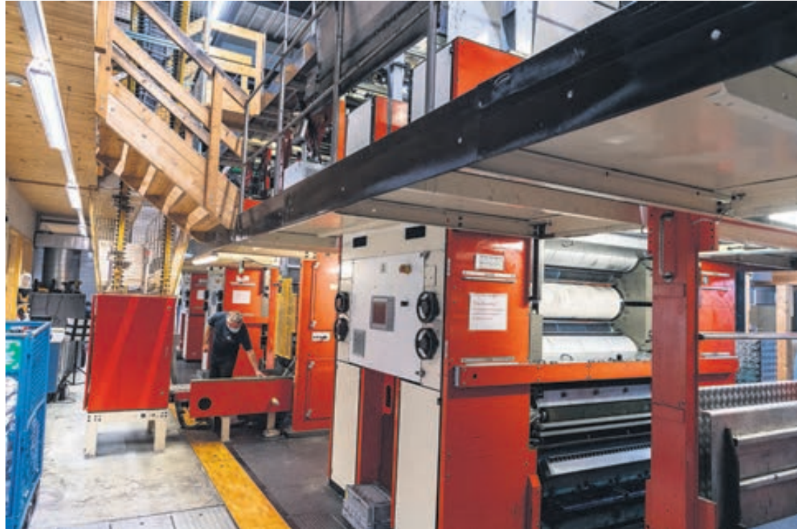
La rotative est composée de quatre blocs et d'une plieuse.
