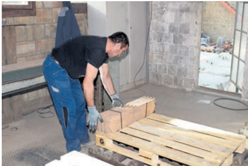
A la sortie du four, les tuiles refroidies sont triées à la main, toutes les abîmées ou qui n'affichent pas la bonne teinte sont écartées, avant d'être conditionnées sur des palettes.
