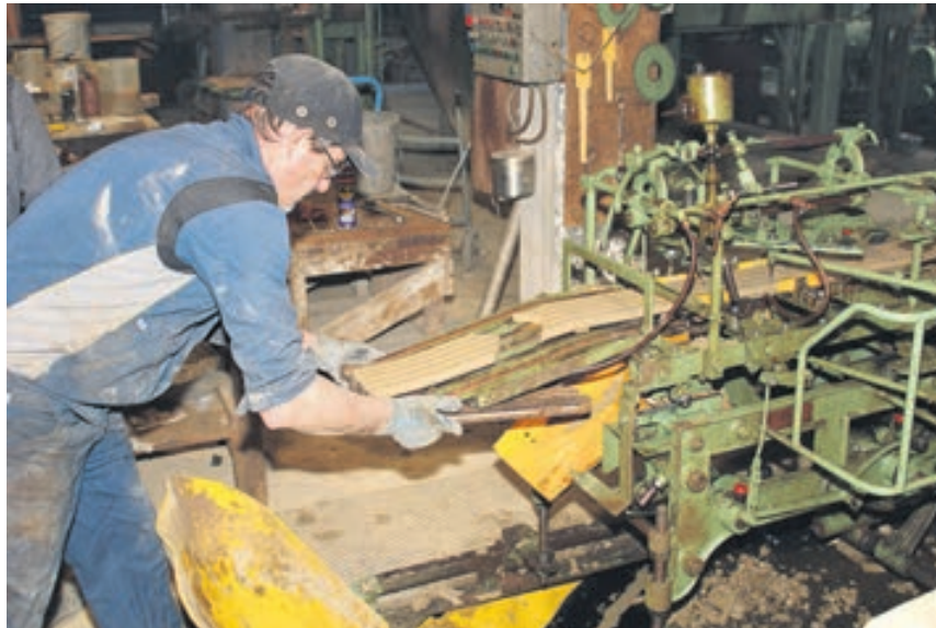
Sortant d'une machine sous la forme d'un long ruban, l'argile est moulée et découpée en tuiles récupérées une à une au bout du tapis roulant. La tuile plate cannelée est le produit phare de Bardonnex.
