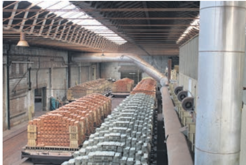
Après la phase de séchage, les tuiles sont empilées sur des wagonnets. Toutes les quatre heures, l'un de ceux-ci entre dans le four de près de 100 mètres de long qu'il va mettre sept jours à parcourir.
