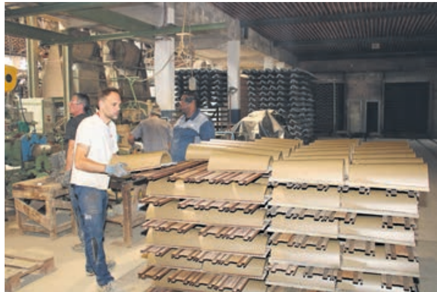
Certaines pièces, comme les tuiles canal pour le faitage, sont façonnées à la main. Après la fabrication, les tuiles sont séchées durant six jours sous des ventilateurs.
