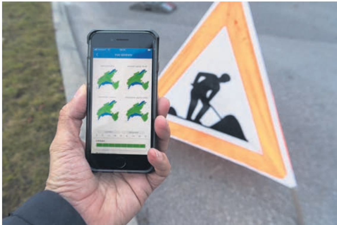
Une carte en vert, les travaux de construction peuvent se poursuivre. Si du rouge s'affiche et que certains critères sont confirmés, les travailleurs doivent être mis à l'abri ou, si ce n'est pas possible, le chantier doit fermer.
