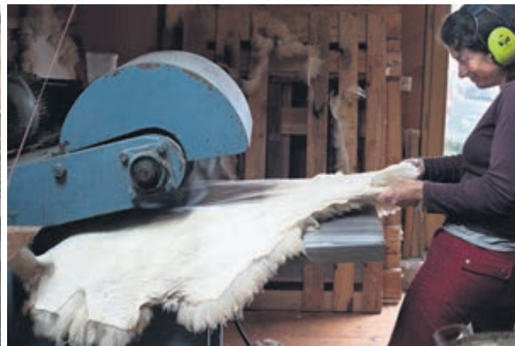
Les peaux sont étirées avec une machine puissante: le palisson inversé.
