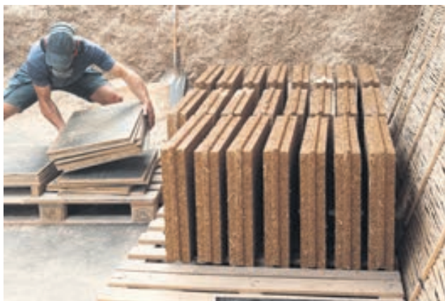
Quand les premiers panneaux de 10,5 centimètres d'épaisseur sortent du ventre d' Iris , ils sont mis sur chant, soit sur l'arête, jusqu'à devenir tout à fait secs.
