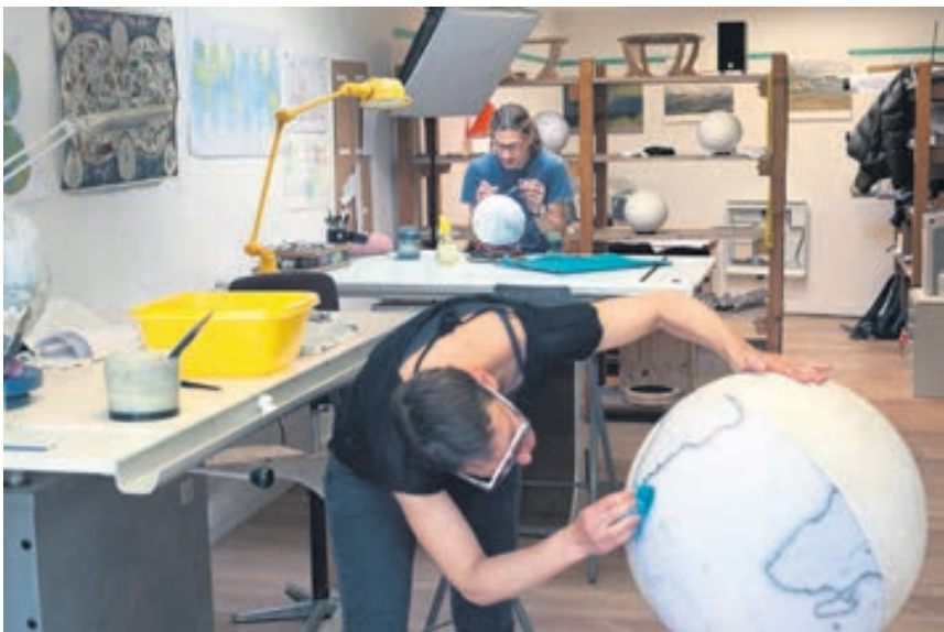
Un logiciel sur mesure – La carte que Cécile et Alain apposent sur les globes, Alain l'a lui-même dessinée à l'ordinateur. Puis, il a créé un logiciel pour transformer la représentation de la carte en fuseaux.
