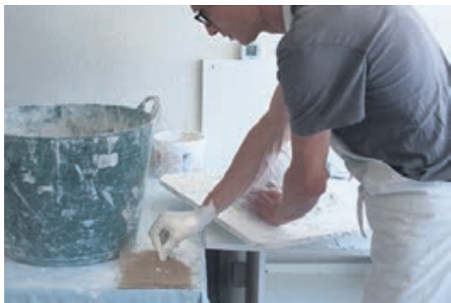
Toile de jute – Pour maintenir le mélange et solidifier le globe, Alain appose des morceaux de toile de jute imbibés de plâtre.
