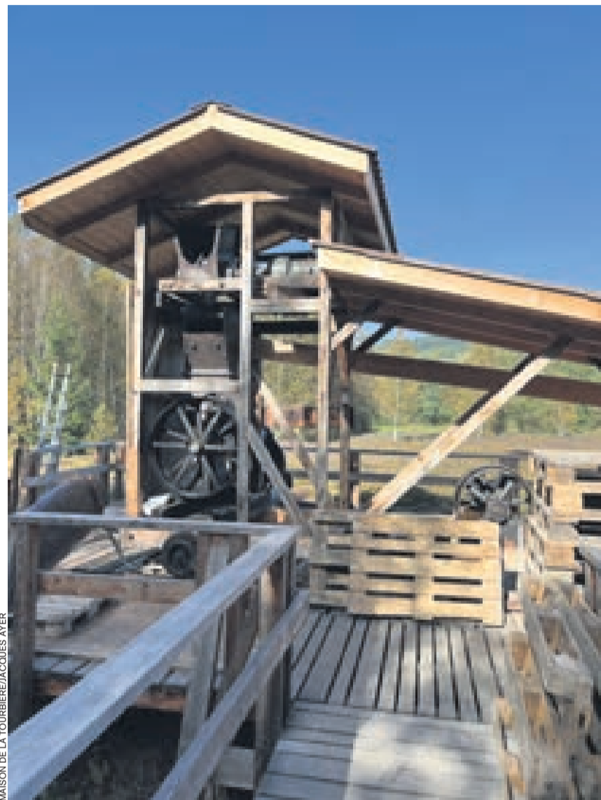
Remise en état de marche par des étudiants en conservation-restauration de la Haute Ecole Arc, cette malaxieuse, qui est une des attractions du Sentier de la Tourbière, servait à mélanger la tourbe afin de l'homogénéiser.
