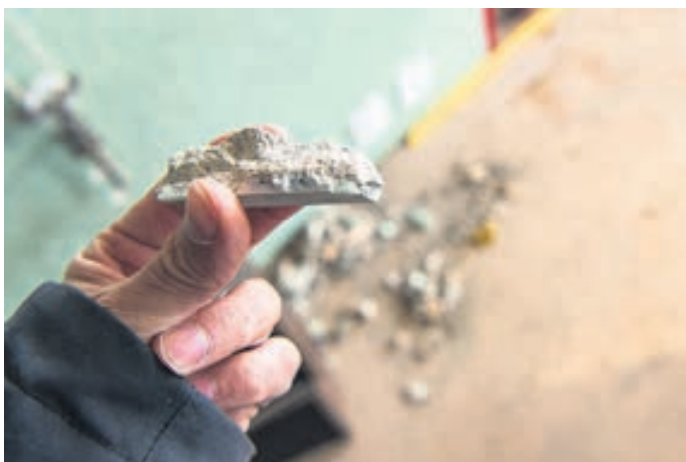
L'amiante se loge partout, ici dans la colle du carrelage.
